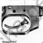
Abb. 70: MG 81; Herausnehmen des Abzugshebels
