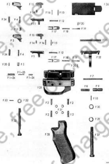
Abb. 31: MG 81; Abzug Z; Einzelteile
