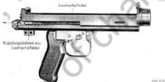
Abb. 59: MG 81; Herausnehmen der Laufvorholeinrichtung
