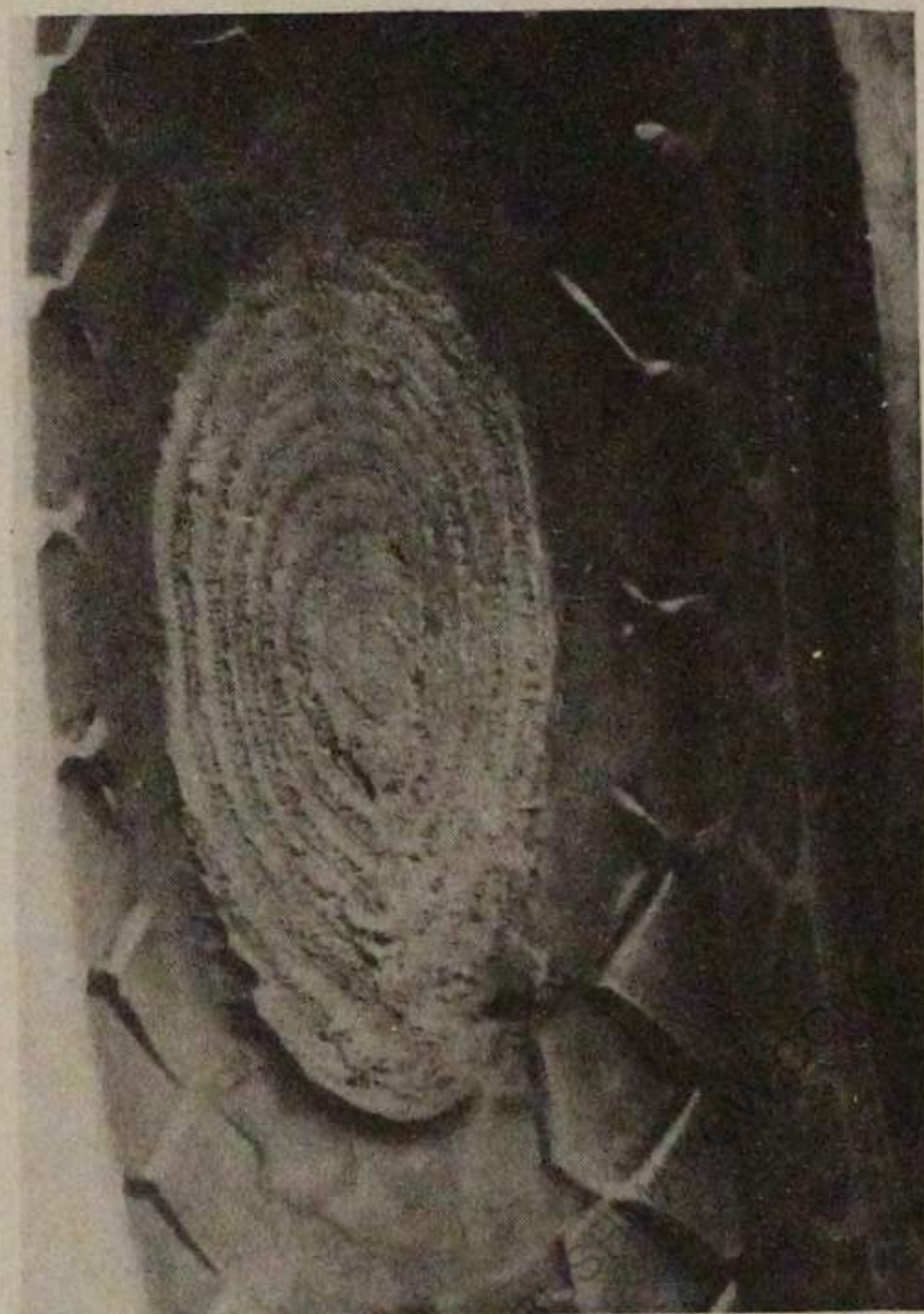
Bild 14 Luftreifen, Laufstreifen durch scharfes Bremsen zerstört
