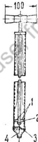
Рис. 88. Шприц для заправки маслом: 1 — металлические шайбы поршня; 2 — кожаный поршень; 3 — кожаная уплотнительная прокладка; 4 — наконечник (точеный)
