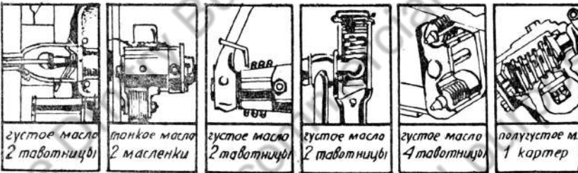
Рис. 89. Карта смазки шасси автомобиля М-1
