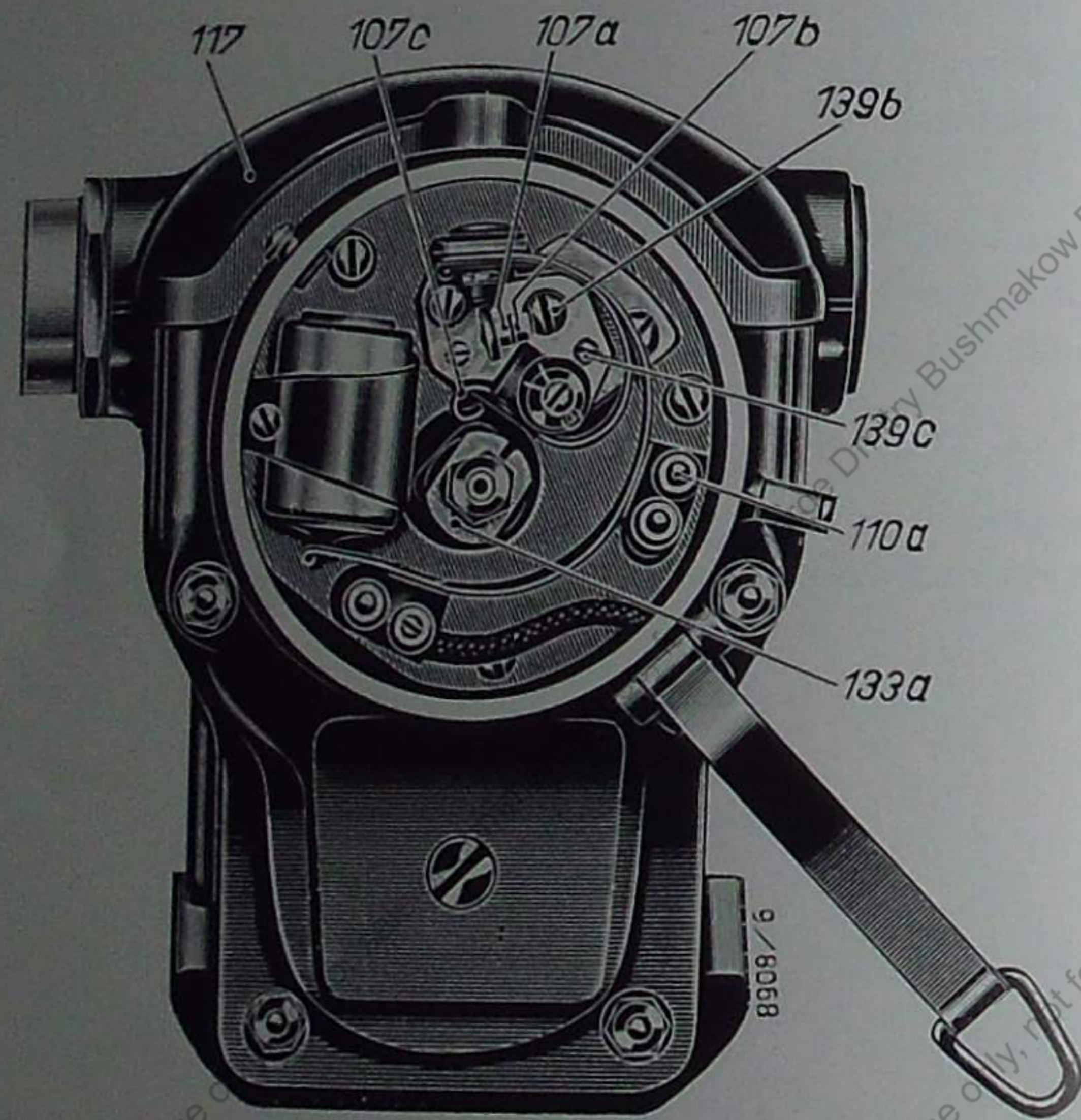
Abb. 28/5 Magnetzünder, Unterbrecherdeckel abgenommen
