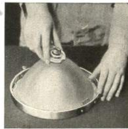
Herausnehmen der Lampenfassung mit der BiLuxlampe
