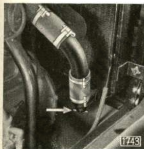
Kühlwasserablaßhahn am Auslaßstutzen
