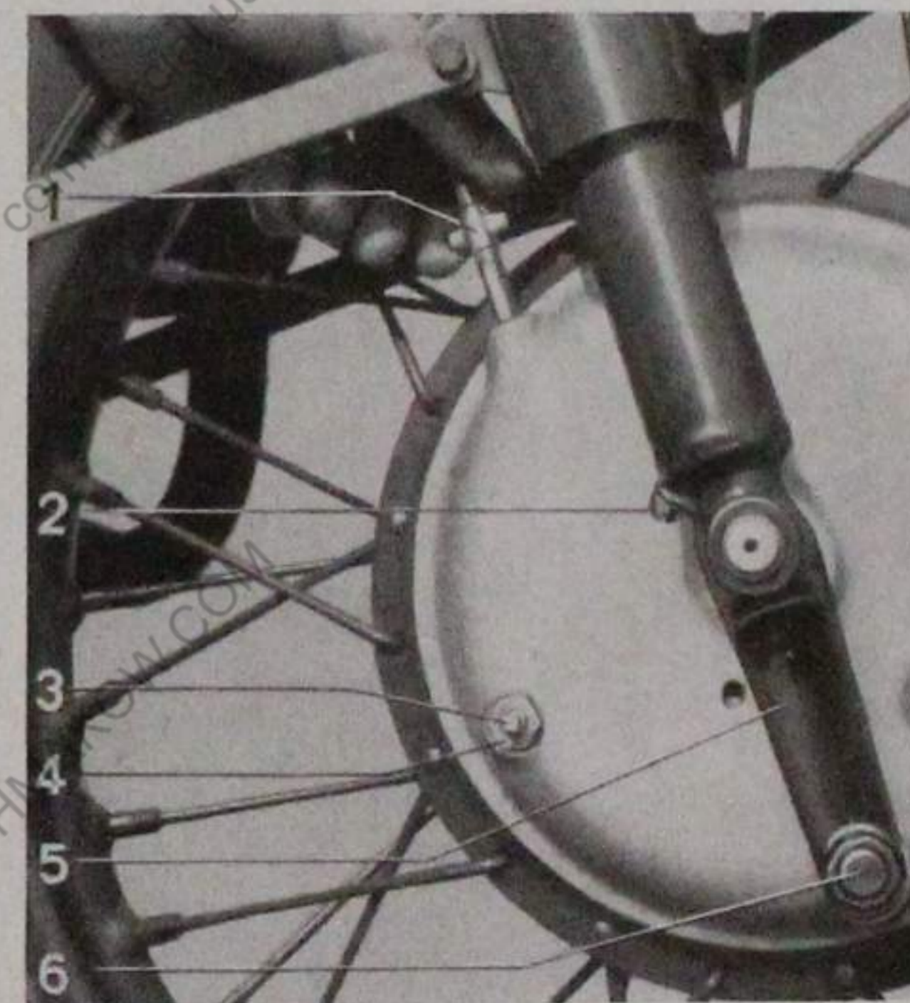
Nachstellen des Bremsseiles
