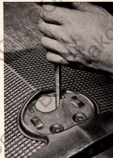
Bild 24. Einfeilen der Dreieckspitze in die Kühlerverkleidung
