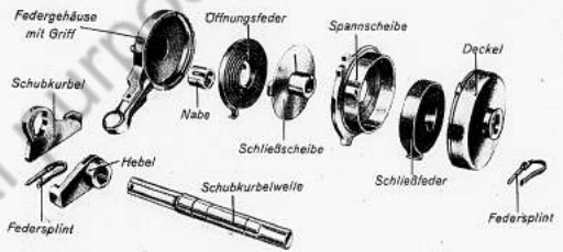
Federehäuse mit Griff Schubkurbel Federsplint Hebel Nabe Schubkurbelwelle Offnungsfeder Spannscheibe Schließscheibe Schließfeder Deckel Federsplint
