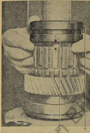
Bild 379: Schiebehülse für 3. und 4. Gang aufsetzen 1 Schiebehülse für 3. und 4. Gang 2 Eingezätzte Pfeile müssen sich gegenüberstehen
