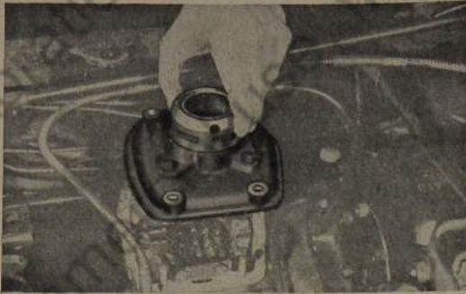
Bild 454: Schaltturm mit Sperrplatte abheben
