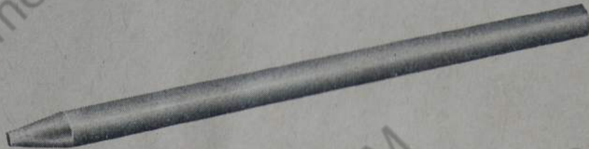
Dorn zum Austreiben der Gleiskettenbolzen
