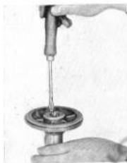
Gewindestift am Kolbenboden mit Schraubenzieher ausschrauben.
