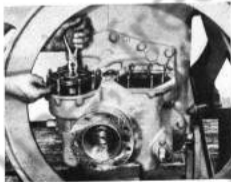
Kupplungskolben mit einer Zange herausziehen.
