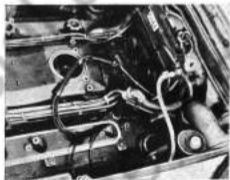
Zündleitung aus der Zylinderkopfaube etwa 10 cm herausziehen
