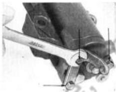
Sicherungen der Deckelbefestigungsschrauben aufbiegen. 3 Deckelbefestigungsschrauben mit Schlüssel SW 10 ausschrauben, dabei auf Federdruck achten.
