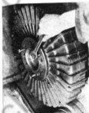
Bremstrommel mit 3 Abdrückschrauben 14X90 (SW 22) abdrücken.
