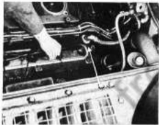
Entstörtschlauch mit Schlüssel SW 36 abschrauben.
