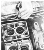
Ausgleichdüse mit Schraubenzieher ausschrauben.
