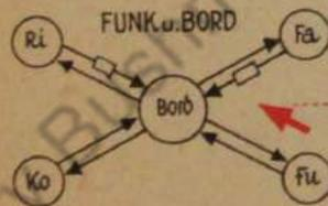
Die 4 Bordsprecher sind als Kreise eingezeichnet. Senden und Empfangen als Pfeile. Geht der Sendepfeil durch die Mikrophontaste, dann muß sie beim Sprechen gedrückt werden.
