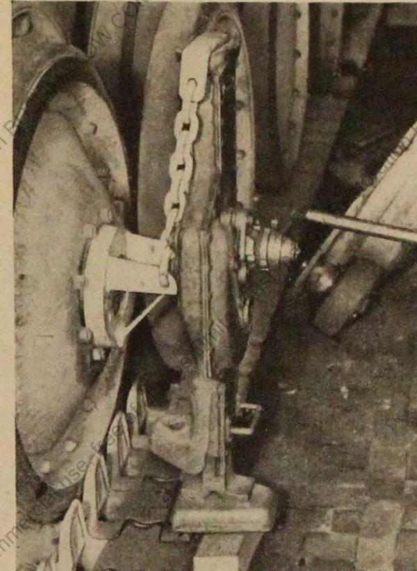
3. Hebevorrichtung mit 2 Sechskantschrauben M 16×55 an die Laufradnabe anschrauben.
